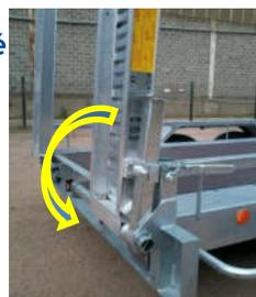
Le simple déverrouillage de la fermeture excentrique libère le béquillage et les rampes
